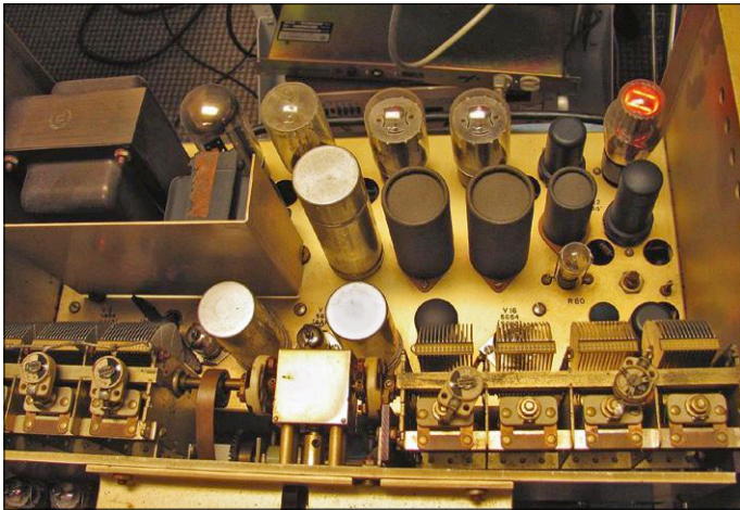
Figuur 2. Bovenaanzicht van de generator in originele staat. Links bovenaan de voedingstransformator, in mijn exemplaar helaas defect. Rechts daarvan de smoorspoel van 6 H (ja, henry). De zes buizen op de achterste rij behoren alle tot de voedingsstabilisatie. NB deze foto werd gemaakt, lang vóórdat bekend was dat er een Elektor-artikel gewent was!
